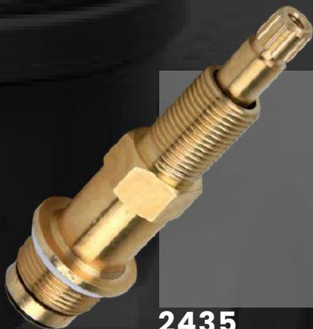
Material latón, PVC y nylon, cuerpo y vástago de latón, empaque asiento y o-ring de PVC negro, empaque de nylon, durables y resistentes, medida 9.7 cm.
